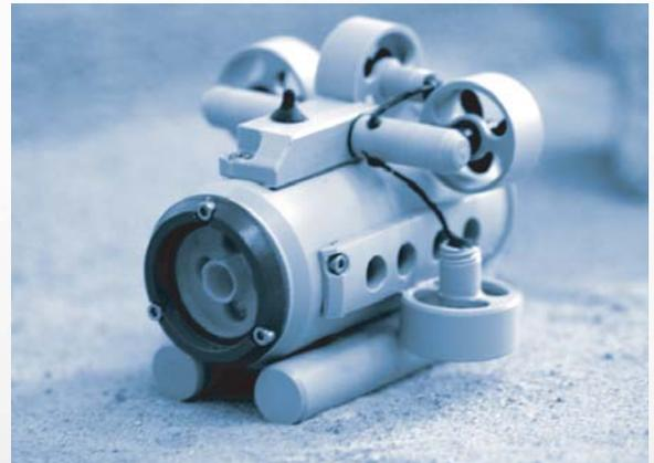
genauso angesteuert wie die in der Tiefsee verwendeten akustischen Sensoren und kann somit aus Perspektive der Verhaltenssteuerung als äquivalent gesehen werden. Mit einer Länge von 12 cm und einem Durchmesser von 5,5 cm am Druckkörper handelt es sich beim  $\mu$ AUV im Moment um das kleinste vollautonome AUV der Welt.
