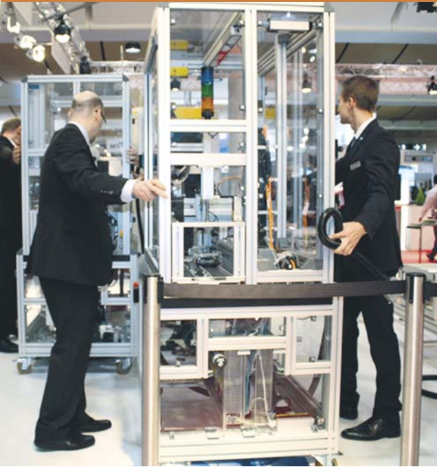
Plug'n'Produce – Austausch eines Produktionsmoduls
