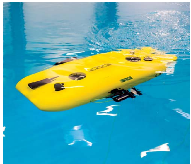
Autonomous Underwater Vehicle (AUV) Dagon wird für eine Testfahrt zu Wasser gelassen.
